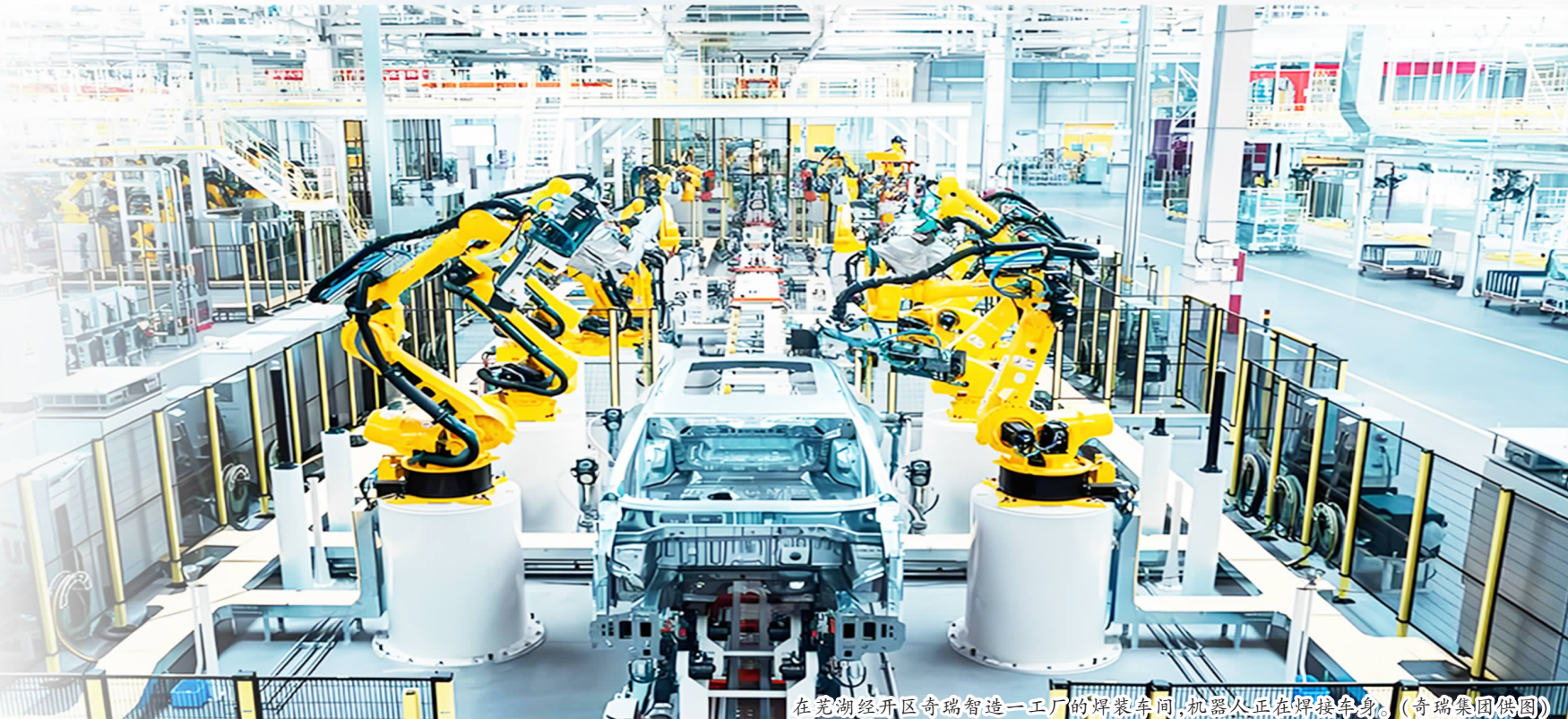
在芜湖经开区奇瑞智造一工厂的焊装车间,机器人正在焊接车身。(奇瑞集团供图)
