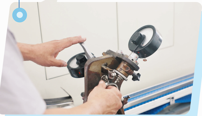
安徽贝姆轴承科技有限公司,技术员测量轴承尺寸
