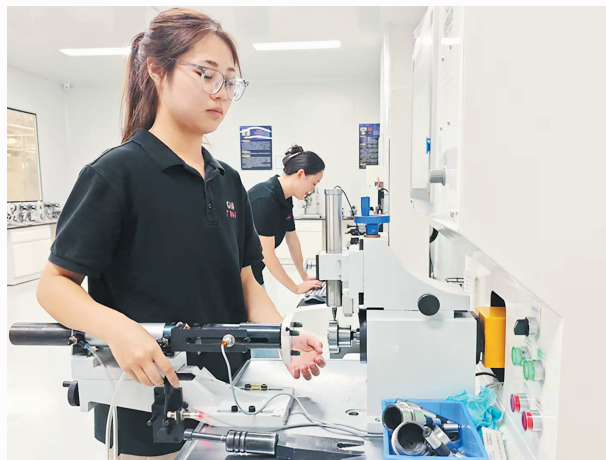
安徽广鑫轴承科技有限公司,工作人员操作手动测振机对轴承震动进行检测。 李东标/摄
