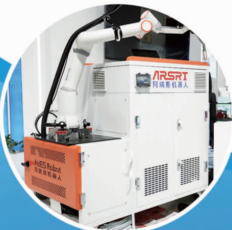
宣城阿瑞斯智能机器人有限公司展示协作焊接机器人。
