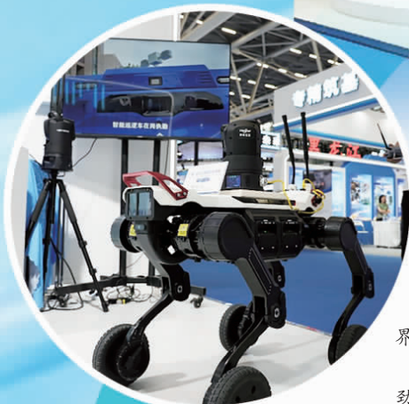
安徽清新互联信息科技有限公司展示搭载黑光全彩智慧视觉终端的智能巡检四足机器人。
