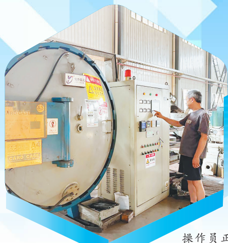
操作员正通过数字屏幕调节热处理工艺参数,确保模具钢材性能精准达标。(叶静/摄)
