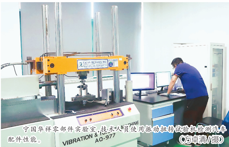
宁国华祥汽车零部件实验室,技术人员使用振动扭转试验机检测汽车配件性能。(万卓清/摄)
