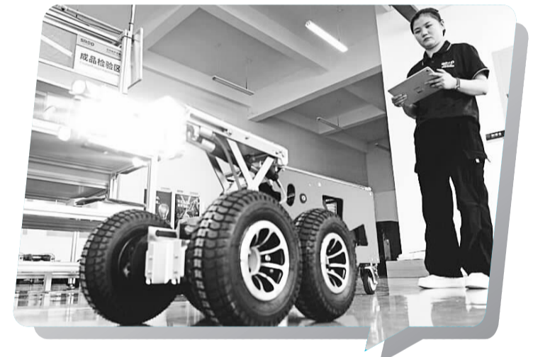
位于淮南经济技术开发区内的淮南和亿德科技有限公司，自主研发适合不同场景的智能巡检机器人，广泛运用于排水、供水、燃气、热力等“城市生命线”巡检，让城市生命线从“事后抢修应对故障”转向“事前排查安全风险”。图为工人在调试智能巡检机器人。
